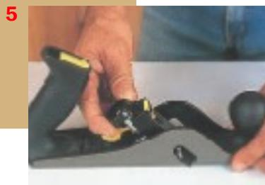
5. Pour "donner du fer" (sortir la lame), tourner le bouton moleté dans le sens des aiguilles d'une montre. Pour "retirer du fer" (rentrer la lame), tourner le bouton dans l'autre sens.
