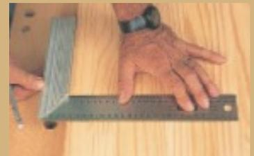
2. Faire pivoter l'équerre et la positionner le long du tracé. Si le bord de l'équerre et le tracé ne coïncident pas, l'équerre est fautive. Il faut la jeter.
