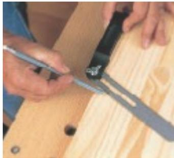
**6.** Pour reporter un angle quelconque, utiliser la fausse équerre que l'on appelle familièrement une "sauterelle". Dévisser la vis de serrage, plaquer les deux bras de la sauterelle contre les plans de l'angle à relever. Serrer la vis.
