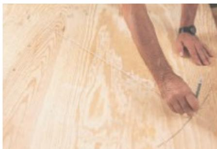
**10.** Autre technique pour tracer un grand cercle : une ficelle fixée d'un côté à une pointe plantée au centre du cercle et de l'autre à un crayon. La longueur de ficelle entre pointe et crayon correspond au rayon du cercle à tracer. Inconvénient de cette méthode, la ficelle a toujours une certaine élasticité et il est impossible de tracer un cercle parfait.
