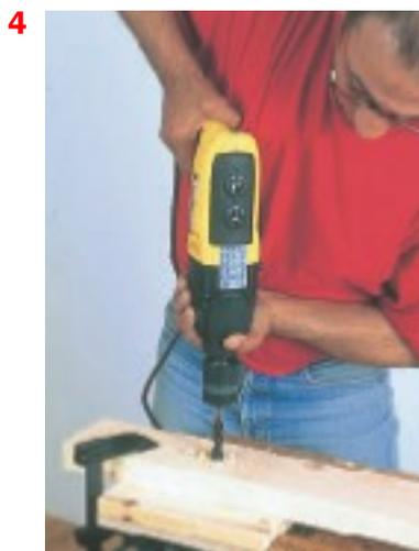
**4.** Pour percer le bois sans éclats avec une mèche hélicoïdale : placer un "martyr" (un morceau de bois) sous la pièce à percer et continuer le perçage dans ce martyr.
