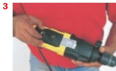
**3.** Régler la vitesse en fonction du tableau imprimé sur la perceuse ou dans sa notice.
