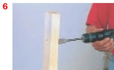
**6.** ... et de l'autre côté, en plaçant la pointe de centrage dans le trou.
