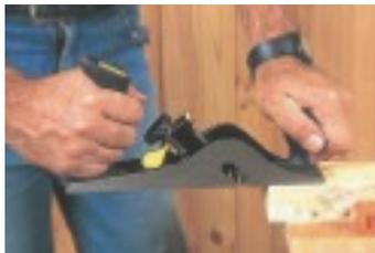
**6. Régler le parallélisme de la lame en déplaçant la manette d'un côté ou de l'autre. Le fer est parallèle lorsque la manette est en position centrale.**
