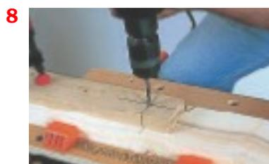
**8.** Un morceau de bois dur, percé avec soin, sert de guide de perçage pour effectuer en série des trous bien verticaux.
