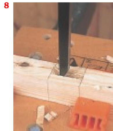
**8. Retourner le bédane et, en le tenant droit, tailler des copeaux verticaux. Lorsque la demi-mortaise est creusée, retourner la pièce et tailler la seconde demi-mortaise.**
