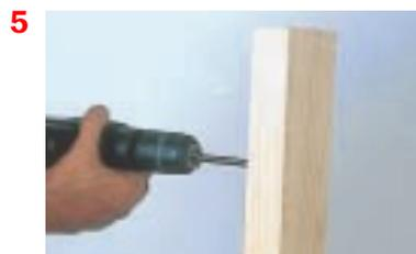
**5.** Pour ne pas faire éclater le bois avec une mèche plate, percer en deux fois : d'un côté jusqu'à ce que la pointe de centrage ressorte à l'opposé...
