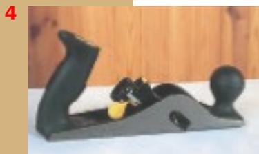
4. ... ou en posant le rabot sur une surface parfaitement plane, par exemple un panneau stratifié.
