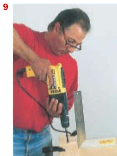
**9.** Lorsqu'il est nécessaire de percer verticalement, s'aider d'une équerre posée à côté du perçage.
