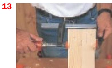
**13.** Pour raboter du bois "de bout" (perpendiculairement au fil), fixer un "martyr" (c'est-à-dire un morceau de bois de même épaisseur) derrière la pièce à raboter et à la même hauteur.
